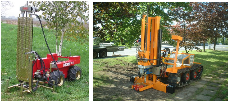
Pagani firmos statinio ir dinaminio zondavimo agregatas (kairėje) ir Švedijos AB Geotech firmos statinio ir dinaminio zondavimo agregatas (dešinėje)
