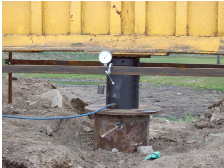
5 pav. Nuosėdžių matavimo indikatorius sumontuotas ant nepriklausomo sijyno
