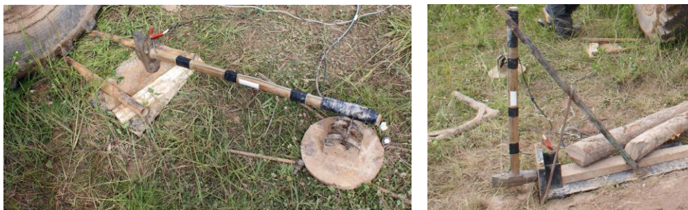
Plaktas su P bangų sukėlimo plokštė (kairėje) ir su S bangų sukėlimo plokštė (dešinėje) (UAB „Geotestus“, 2010)
