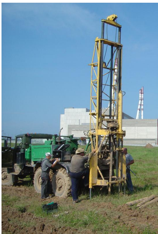
Gręžimo agregatas su sumontuota statinio zondavimo hidrauline spaudimo sistema ant sunkvežimio ZIL-131 bazės (UAB „Geotestus“, Visaginas, 2012)
